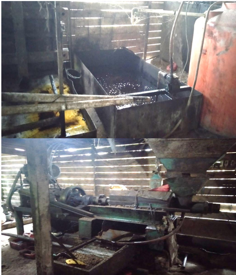
Mesin pengolahan kopra menjadi minyak kelapa
