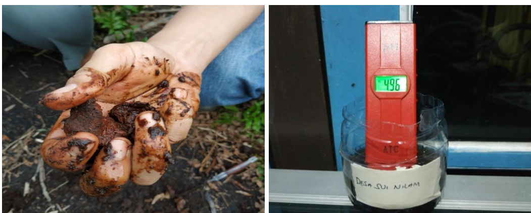
Gambar 16. Dokumentasi Sampel Tanah Gambut dan Pengecekan Keasaman Gambut Desa Sungai Nilam
