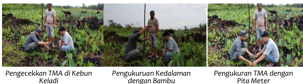
Gambar 15. Dokumentasi Pengecekan Tinggi Muka Air Tanah Desa Sungai Nilam
