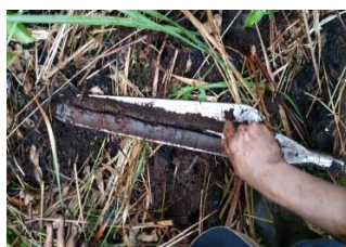
Pengukuran Kedalaman Gambut dengan meteran
