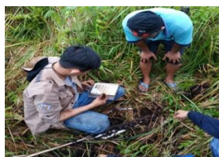
Pengecekan tinggi permukaan air
