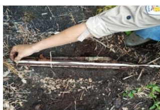
Pengukuran Kedalaman Gambut dengan meteran
